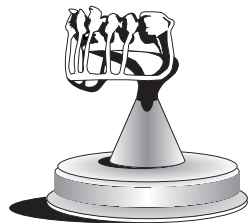
Ring- oder S-Guss 5–6 mm Ø. Vom Ring- oder B-Guss zum Gussobjekt 3 mm Ø.
