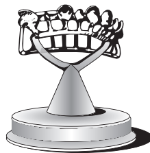
Ring- oder S-Guss 5–6 mm Ø. Vom Ring- oder B-Guss zum Gussobjekt 3 mm Ø.
